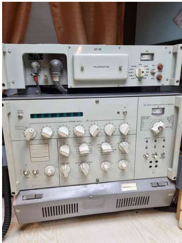
Figur 33: Fra NRKs Spionskipene: «Lira» Dette er radioen som ble oppdaget på «Lira». Det er en analog radio som skal kunne sende og motta morse eller tale. Radioen er av typen HF, som har en svært lang rekkevidde.
