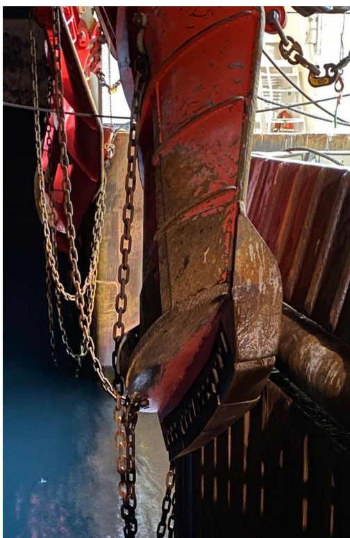
Bilde av tråldørene til Melkart-5 i Båtsfjord i januar 2022. De viser ikke tegn på å være deformerte. Foto: Politiet.
